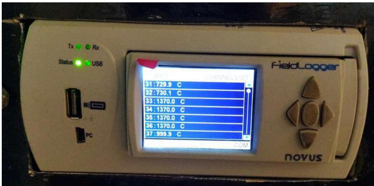
A través del calentamiento con resistencias cubiertas por mantas especiales, se alivia tensión y se reestructura molecularmente una soldadura o pieza, otorgándole mejores propiedades mecánicas y minimizando las posibilidades de fallas.
