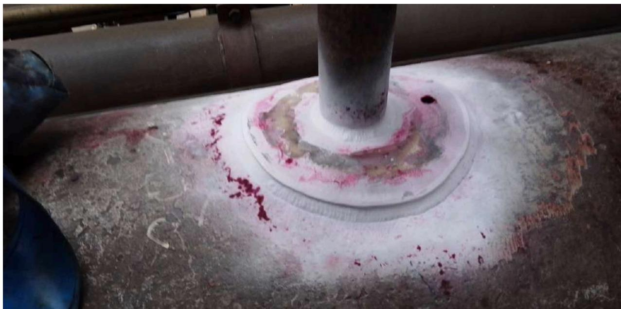
Con la aplicación de una tinta, posterior lavado y aplicado de revelador, podemos encontrar indicaciones superficiales, con luz visible o fluorescente con luz UV.
