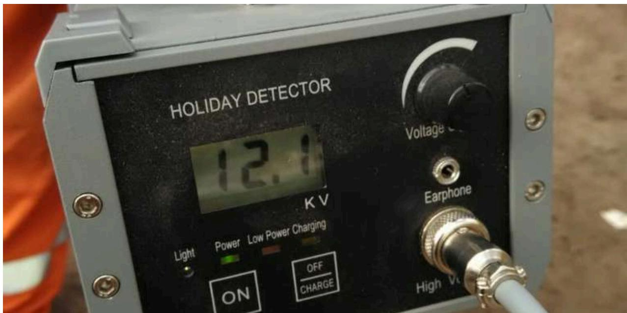
Se hace pasar una corriente de bajo voltaje y con el uso de peines o cintos metálicos se pueden encontrar fallas de recubrimiento.
