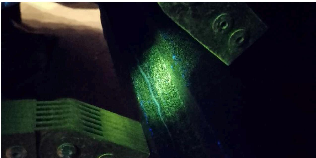
Mediante el uso de una corriente electromagnética y partícula magnetizables visibles o fluorescentes se detectan defectos superficiales y sub-superficiales en el material.
