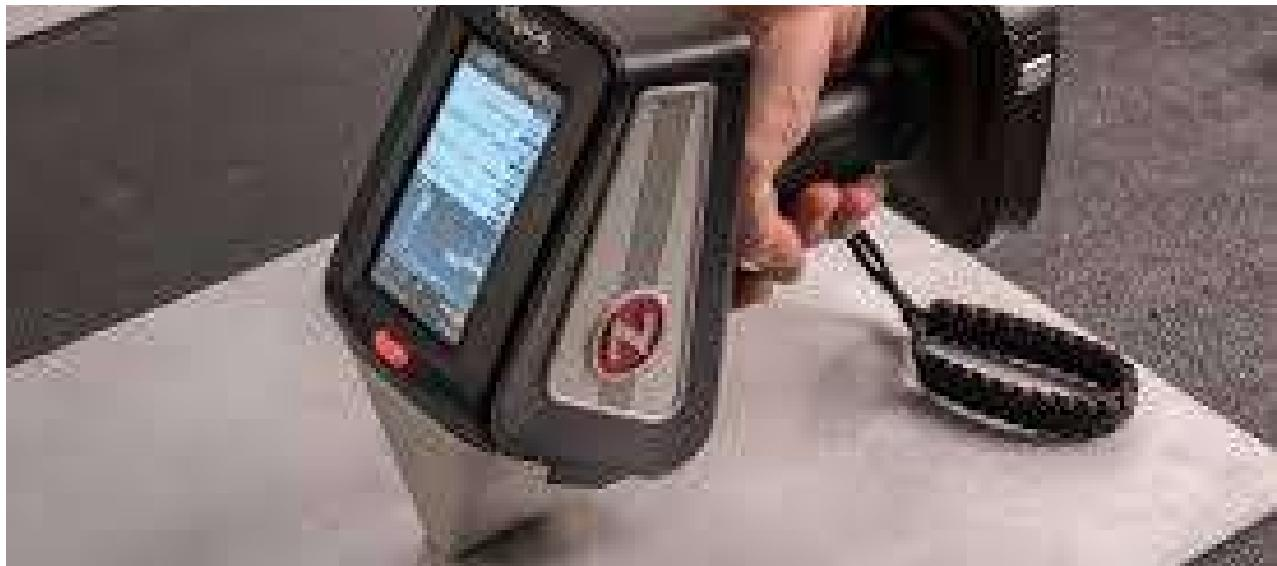
Método que determina la composición química del espécimen identificando distintos tipos de aceros de baja, media y alta aleación, también aceros inoxidables con la capacidad de medir carbono para la resolución de grados y carbono equivalente.
