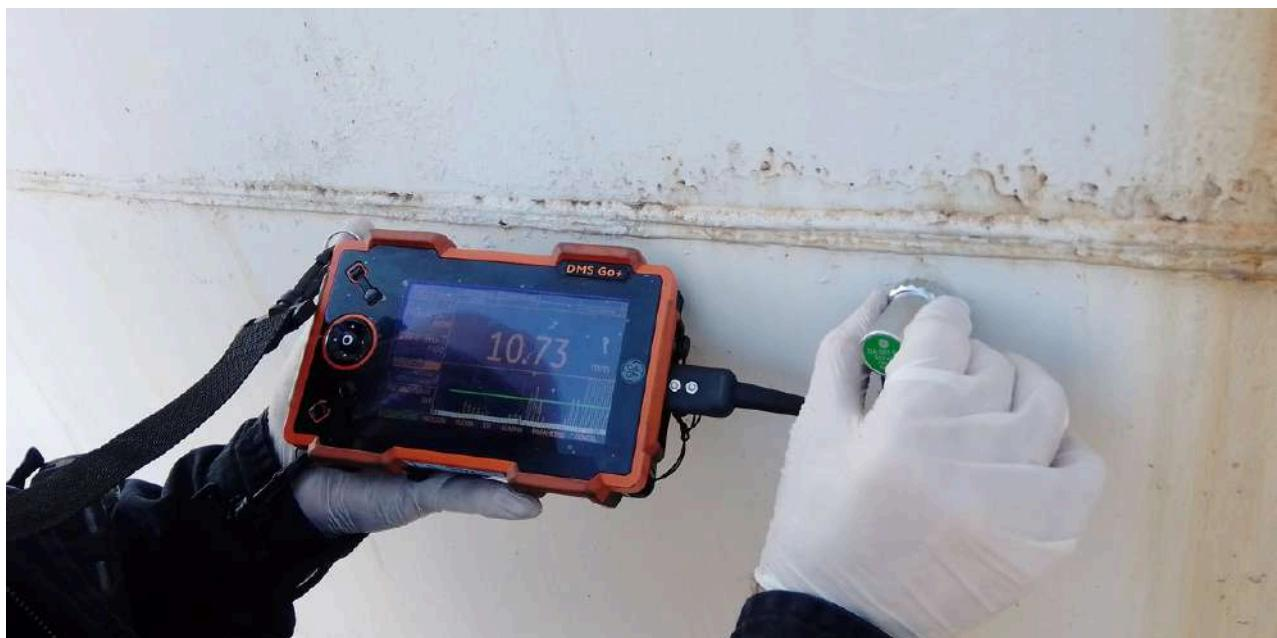
El uso de ésta técnica nos permite obtener el espesor exacto y la presencia de discontinuidades en chapas, caños y accesorios.
