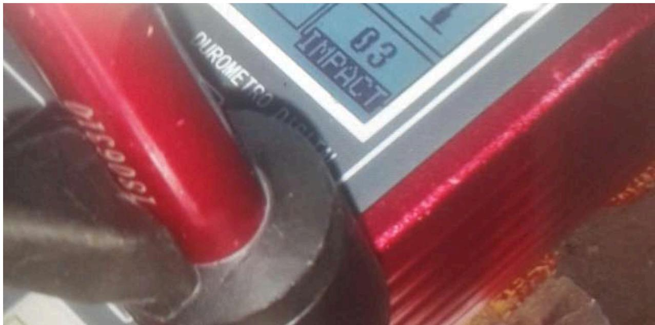
Los ensayos de dureza permiten determinar, de manera rápida, la resistencia de un material a ser dañado, rayado o penetrado por una pieza de otro material distinto y su estado de endurecimiento, de esta manera podemos demostrar que la dureza del espécimen este dentro y cumpla con los parámetros requeridos de las propiedades mecánicas del material.
