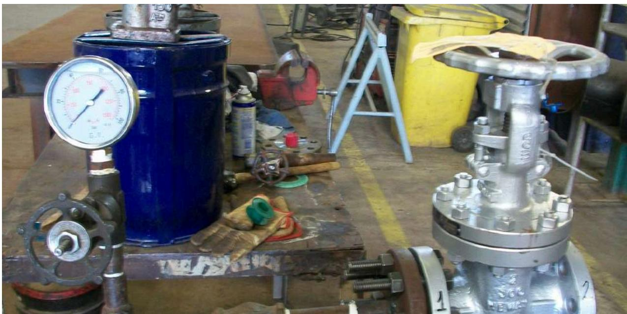
Pruebas Hidráulicas y Neumáticas con controlador Digital (Data Logger)
