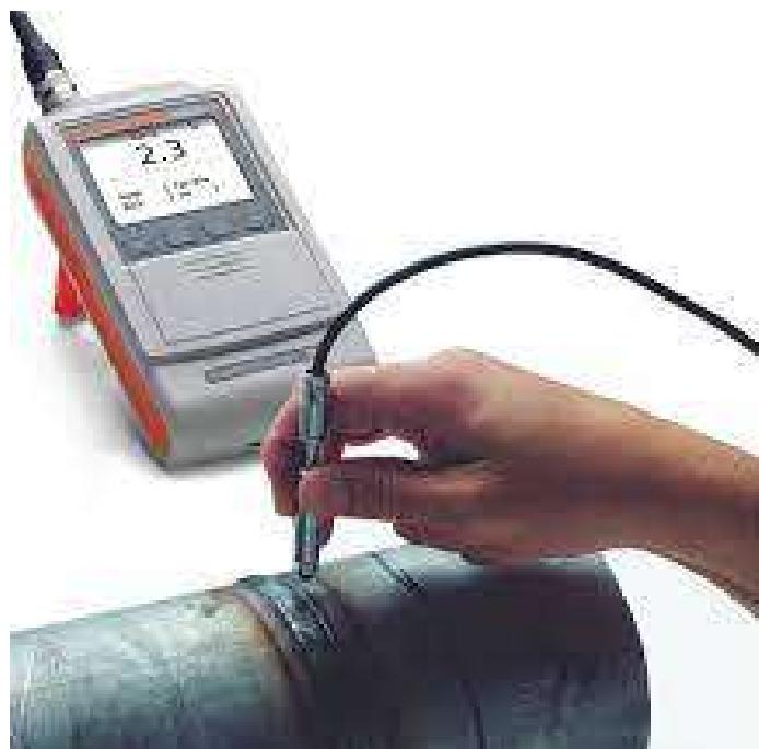
Los ensayos de Ferrita son una manera rápida, económica y precisa de medir el contenido de ferrita delta en aceros inoxidable austeníticos y dúplex.
